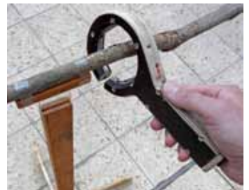
Der Optische Ringsensor im Einsatz. Der „Heiße Draht“ ist hier ein Ast, der auf einer Stütze mit durchsichtigem Hals aus Plexiglas befestigt ist
