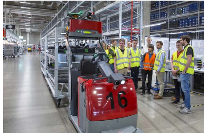
Fahrerloses Flurförderzeug in der Vormontage Cockpit
