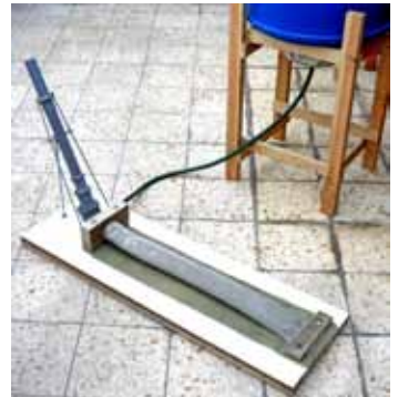
Wasserkanone mit 300l-Vorratspeicher mit unten liegendem, automatischem Nachladesystem.
